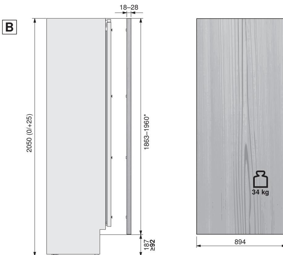
\* = При высоте ниши > 2064 необходимо отрегулировать расположение отверстий в дверной панели и высоту дверной панели.
