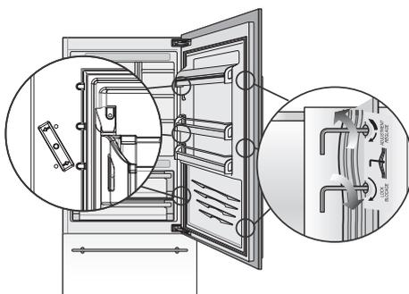
► **7) Вертикальное выравнивание** выполняется путем затягивания или ослабления винта на уголке. Переместить дверную панель вверх/вниз соответственно.
