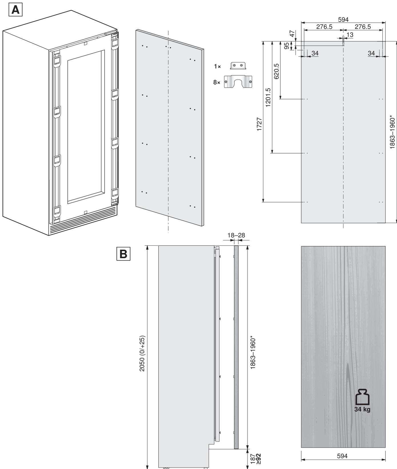
\* = При высоте ниши >2064 необходимо отрегулировать расположение отверстий в дверной панели и высоту дверной панели.
