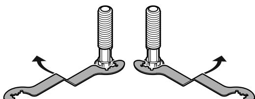
Поворачивайте ключ по часовой стрелке, чтобы приподнять прибор, или против часовой стрелки, чтобы опустить его.
