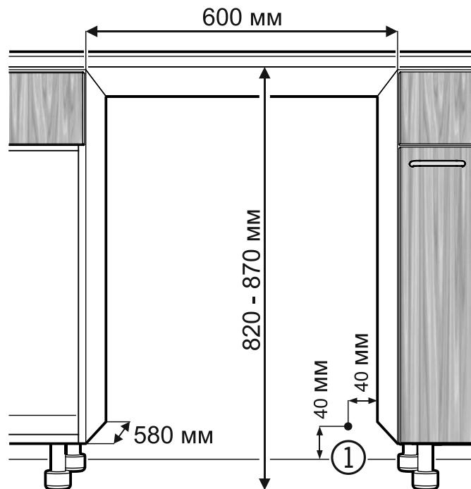
(1) В этом месте стыльной стороны прибора прокладывается провод подключения к сети.
