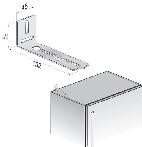
5. В качестве защиты от опрокидывания или для предотвращения сдвига приборов из-за закрывания дверцей можно установить один или два уголка вокруг промежуточной зоны. Уголки не должны прикручиваться к задней стенке прибора.
