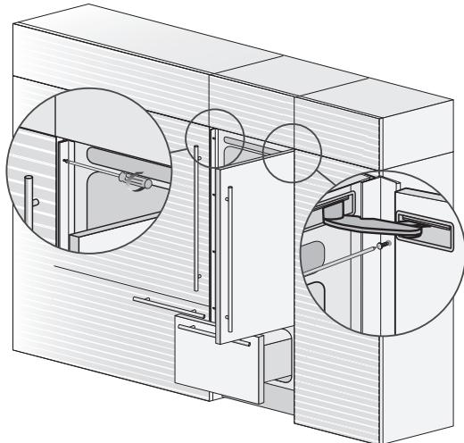
2. Прикрепить прибор к окружающей мебели, прикрутив к нему боковые пластиковые соединительные уголки. Для удобства манипуляций оставить дверцу прибора и ящик открытыми.
