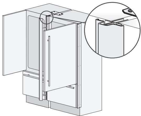
4. Надвинуть пластиковые планки обшивки или промежуточную пластиковую планку обшивки сбоку на уголок, а затем плотно прижать до «щелчка».
