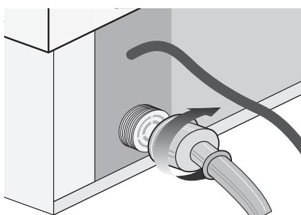
В комплект поставки входит внешний набор водяного фильтра. Магистральный трубопровод водяного фильтра и водопровод должны быть подготовлены до окончательной установки морозильного шкафа; подключение водоснабжения на задней панели прибора с комплектом водяного фильтра должно быть выполнено перед установкой модуля. Комплект водяного фильтра должен быть установлен в легко доступном месте (например, в соседнем шкафу или ниже), чтобы можно было ежегодно заменять вкладыш водяного фильтра.
