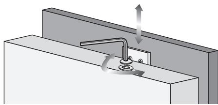
8. Настройка глубины: Поднять уплотнение внутри ящика/дверцы прибора. Верхнее отверстие отвечает за снятие или вытягивание, а нижнее отверстие фиксирует ящик/дверцу.
