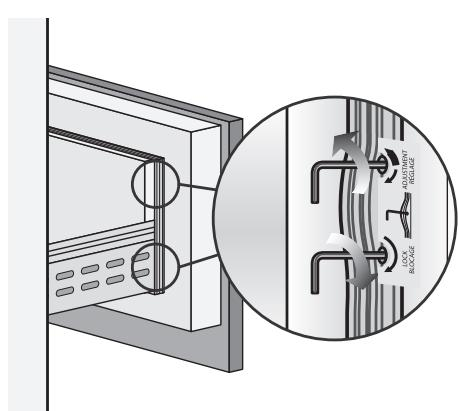
4. Настройка глубины: Поднять уплотнение внутри ящика/дверцы прибора. Верхнее отверстие отвечает за снятие или вытягивание, а нижнее отверстие фиксирует ящик/дверцу.
