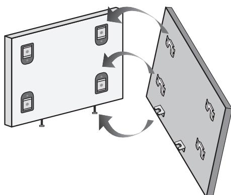
2. Навесить дверную панель ящика на крепежные приспособления, начиная снизу.
