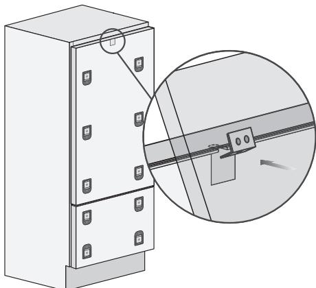
6. Теперь можно отрегулировать дверную панель относительно окружающей мебели с помощью держателей и выравнивающих уголков.
