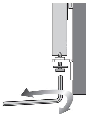
3. Выровнять дверную панель держателями и крепежными уголками относительно окружающей мебели. Затягивая или ослабляя винт на уголке, перемещать плиту вверх или вниз или, если винты ослаблены, вправо или влево, чтобы совместить их по центру с другой кухонной мебелью.
