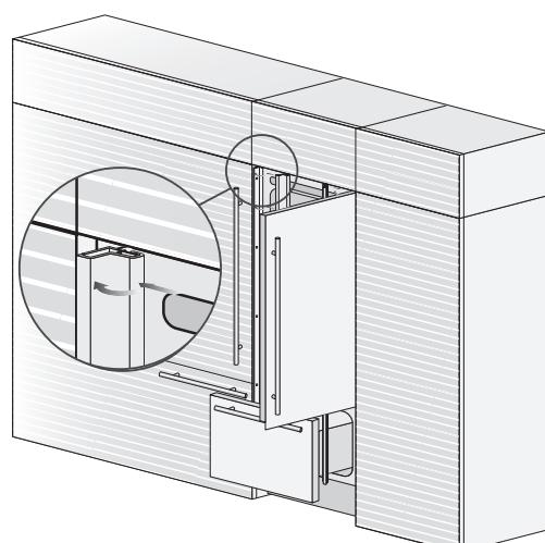
3. Установить планки обшивки на уголок, сдвинув их вбок, а затем надавив на них, пока они не защелкнутся с характерным звуком.
