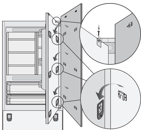
7. Вертикальное выравнивание выполняется путем затягивания или ослабления винта на уголке. Переместить дверную панель вверх/вниз соответственно.
