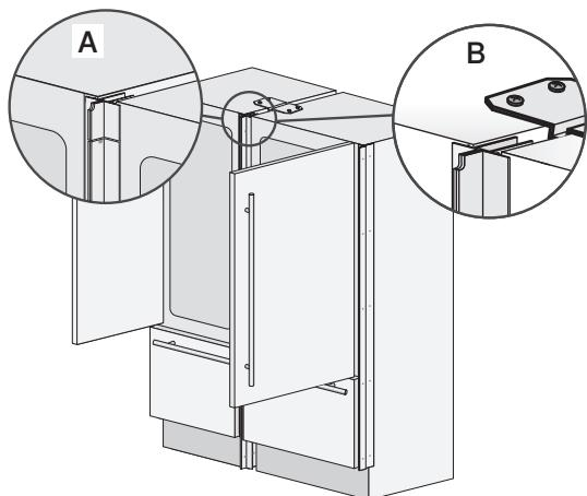
3. Сомкнуть приборы спереди и закрепить их, скрутив вместе боковые пластиковые соединительные уголки (A).
