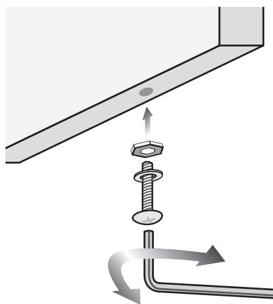
1. Частично затянуть винты с гайками и шайбами. Гайки находятся между нижней частью ящика и уголком дверной панели.
